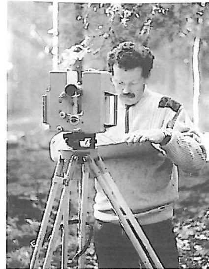
Vermessungstechniker Walter Stoll vom Flurneuerungsamt Bad Säckingen ermittelte mit einem elektronischen Tachymeter die höchste Stelle des Dachsbergs .
